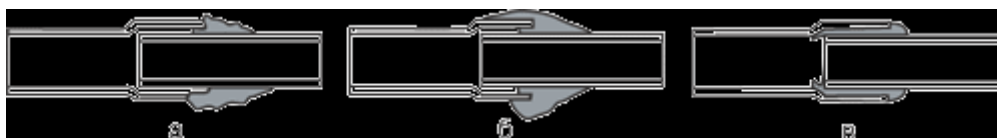
Рис. 7. Распределение припоя в соединении труб:
