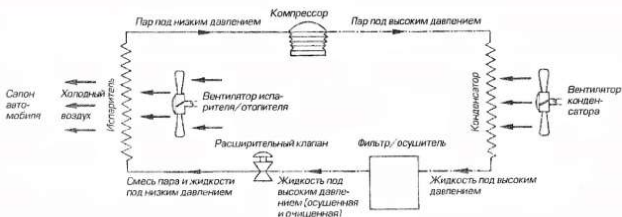
Рис.1. Типичная система кондиционирования с расширительным клапаном
